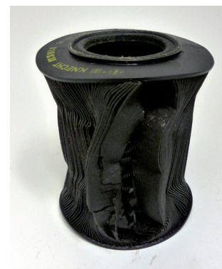
Zdjęcie 3. Wkład filtra oleju przegrzania zdeformowany/rozerwany wskutek
