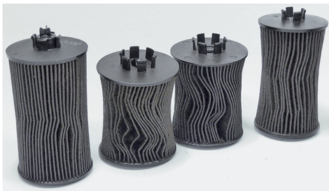
Figure 1 : Affaissement des cartouches de filtre à huile
